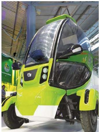
Внешне автомобиль выглядит как полупрозрачная капсула на трех колесах. Водитель управляет им с помощью джойстика, а вместо приборной панели – планшетный компьютер. Во время парковки электромобиль способен трансформироваться в течение 5 секунд. Он словно складывается, приподнимая при этом кабину с шофером, и занимает в 1,5 раза меньше места, чем во время движения. Машина развивает скорость до 90 км/час и способна проехать до 70 км без подзарядки аккумулятора.
